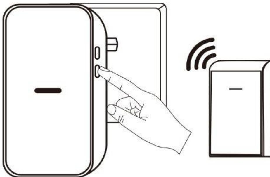
2 Limpar o emparelhamento de códigos: Se o recetor estiver desligado, prima e mantenha premido o "botão de controlo do volume", depois ligue a alimentação até ouvir "bim bam, bim bam", depois solte a mão para limpar todos os emparelhamentos de códigos no dispositivo, depois todos os transmissores serão desactivados e terão de ser novamente emparelhados.
